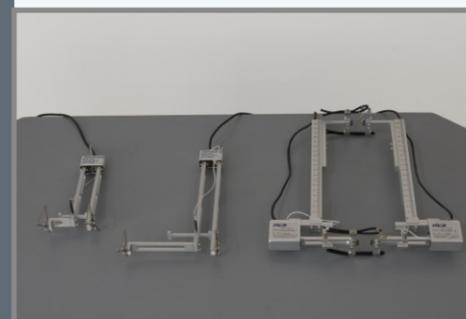
Для измерения деформации образца во время испытаний на растяжение и сжатие, мы предлагаем различные виды экстензометров. Область применения: металл, композит и керамика. Разрешающая способность от 1 мкм, соответствие классу точности 1 и 0,5 по ISO 9513.
